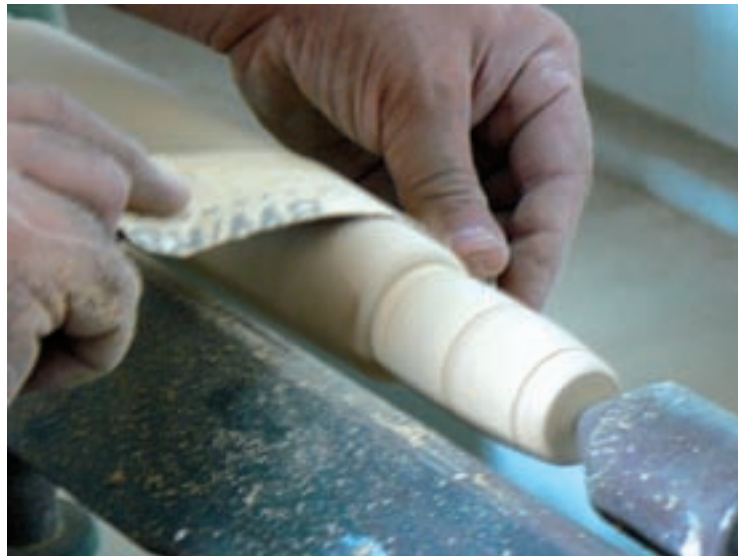
شکل ۹-۵- نحوه سنباده زدن با ماشین خراطی
