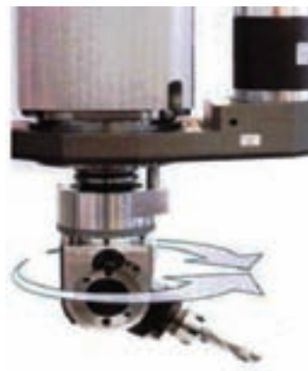
شکل ۳۱-۸- محور c و قابلیت چرخش و زاویه‌پذیری ابزار نسبت به محور z ماشین
