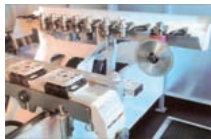
شکل ۸-۳۶- مخزن ابزار به صورت خطی که ابزار در آن با فاصله مشخصی از یکدیگر قرار دارند.
