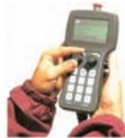
شکل ۳۳-۸- کنترل دستی ماشین که بر روی آن کلیدهای ضروری و پرکاربرد از جمله توقف اضطراری و استپ و استارت و نیز کلید تعویض ابزار تعبیه شده است.
