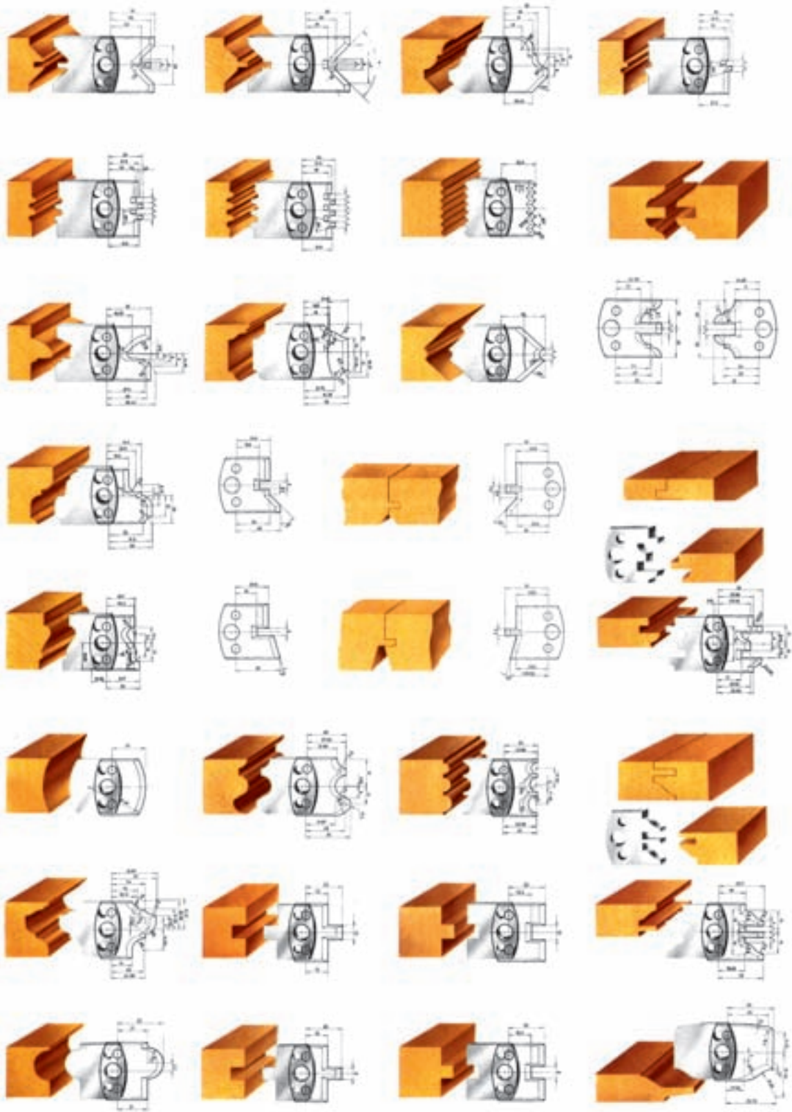
تیغ‌های متعددی که جهت پروفیل‌های مختلف به کار می‌رود نشان داده شده است. در ضمن ابعاد و اندازه‌های هر پروفیل در نمونه‌ها مشاهده می‌گردد.
