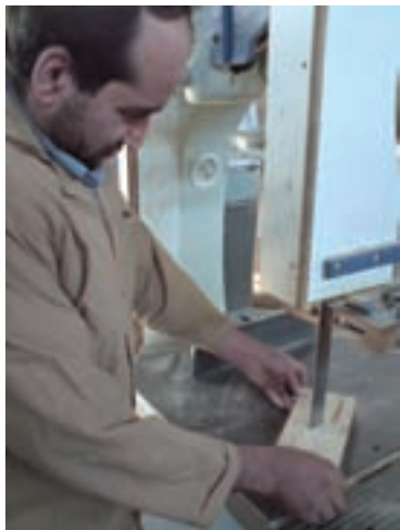
شکل ۱۳-۱- نحوه بریدن قطعات قوسدار
