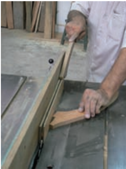
شکل ۱-۴۰- روش کنشکاف زدن
