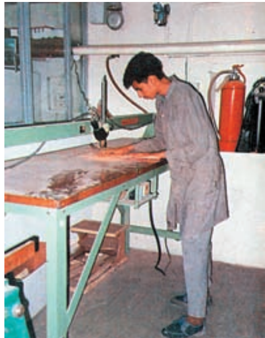
شکل ۱۷-۱- روش کار با اره مشبک‌بری
