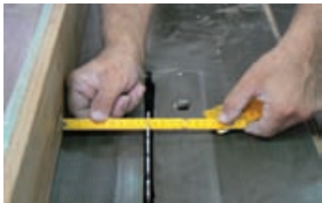
شکل ۱۹-۱- روش تنظیم گونیای اره مجموعه‌ای برای تنظیم عرض برش
