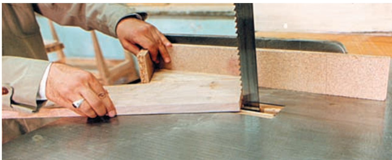
شکل ۱۵-۱- روش استفاده از شابلون برای برشهای مثلی
