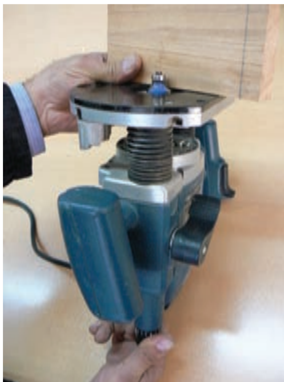
شکل ۱۲۷-۵- روش تنظیم تیغه
