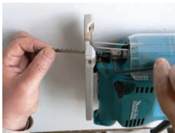
شکل ۲-۴۵ بازکردن تیغه به وسیله‌ی آچار آلن
