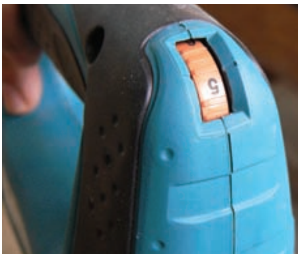
شکل ۳۸-۲ پیچ یا کلید «گاز» اره چکشی از ۱ تا ۶ وضعیت
