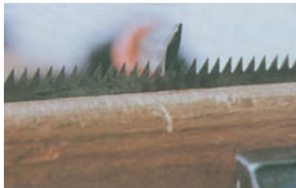
شکل ۲-۶۹ قرارگیری سوهان در بین دندان‌ها
