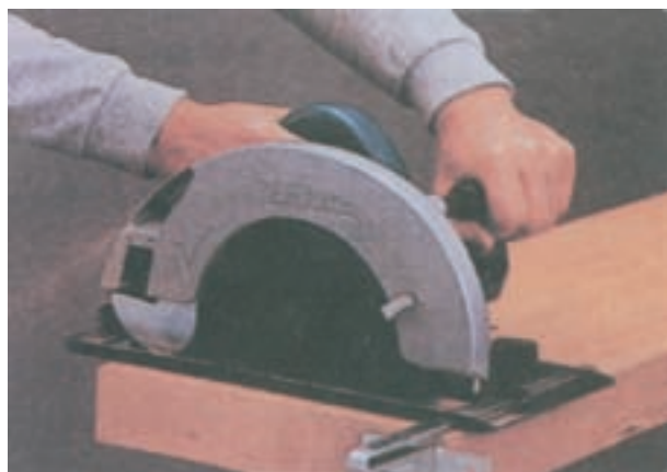
شکل ۲-۲۶- برش به وسیله‌ی گونیای دستگاه
