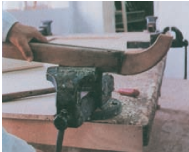
شکل ۲-۶۳- بستن تنگ همراه اره به گرهی رومیزی
