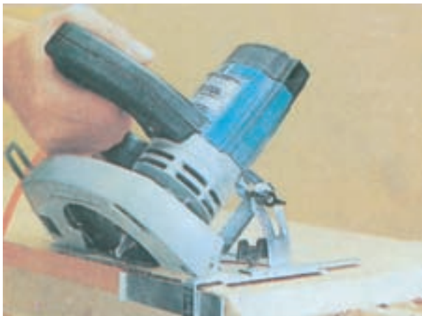
شکل ۲-۲۹- برش تحت زاویه به وسیله‌ی گونیای دستگاه
