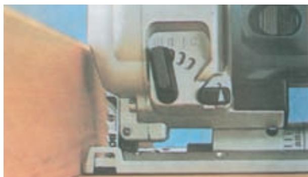
شکل ۳۷-۲ کلید تغییر دور در اره‌ی چکشی
