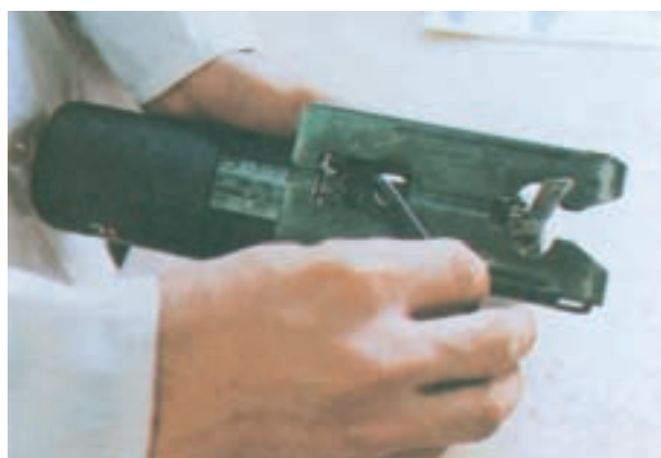
زاویه دار کردن و بستن پیچ آلن
