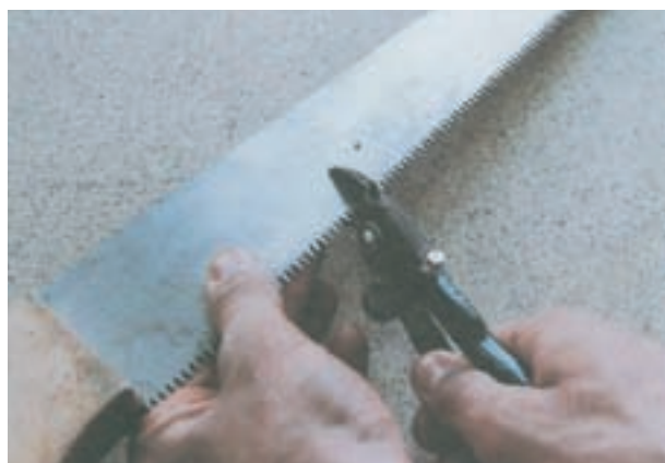
شکل ۲-۶۷ برگرداندن و خم کردن دندان‌های خم نشده
