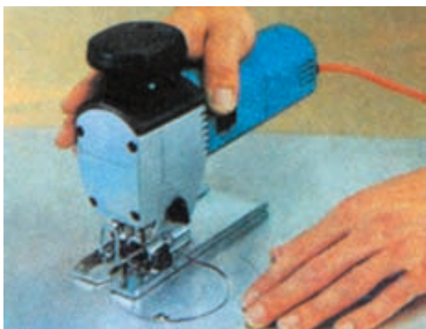
شکل ۲-۳۰- اره عمودبر برقی در حال قوس‌بری
