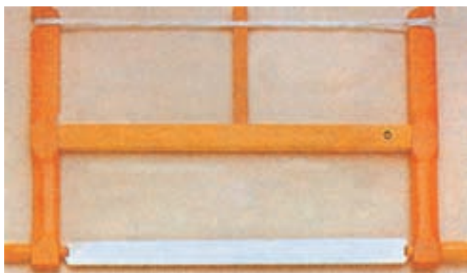
شکل ۲۲-۲-اره کلافی با تیغه شکاف‌زن
