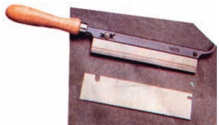
شکل ۲-۱۳- اره ظریف بر با دسته متحرک
