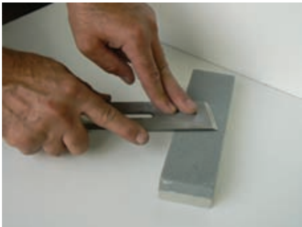
شکل ۳۵-۳- روش برگرداندن پلیسه از پشت تیغه به لبه آن
