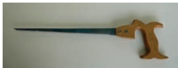
شکل ۱۷-۲-اره نوکی با تیغه متحرک
