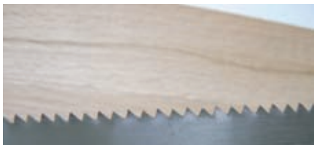
شکل ۱۱-۲- دندانه های اره شکاف زن
