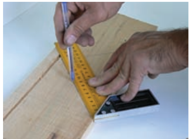
شکل ۱-۵- قسمتهای مختلف یک گونیای ساده و مرکب
