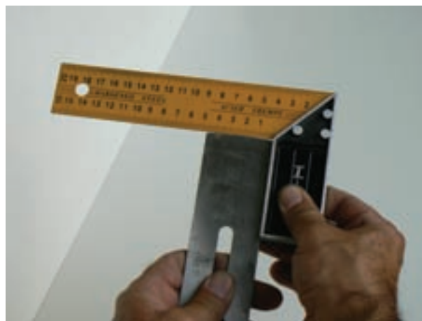
شکل ۳۳-۳- گونیایی کردن سر تیغه رنده
