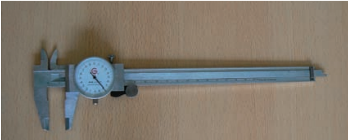
شکل ۱۴-۱— کولیس ساعتی (عقربه‌ای)
