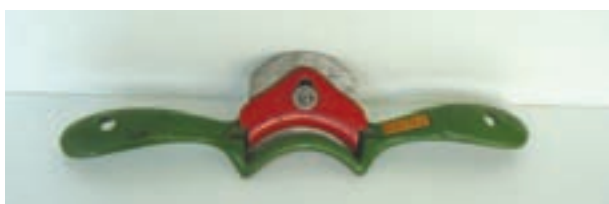
شکل ۳-۳۰ نحوه رندیدن قوسها بوسیله رنده بال کبوتری
