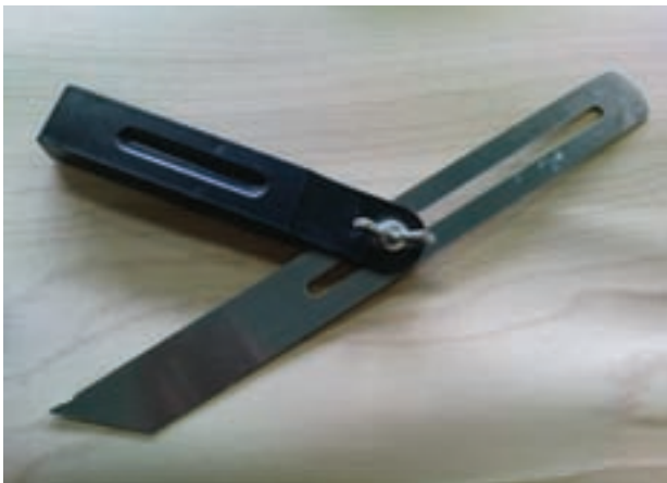
شکل ۷-۱- گونیای فلزی متحرک
