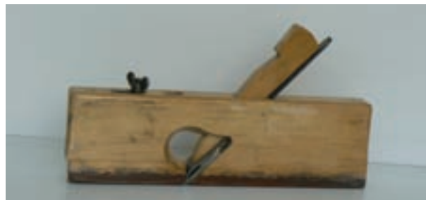
شکل ۳-۲۷ رنده چوبی کنشکاف قابل تنظیم
