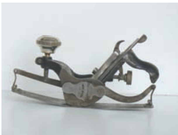
شکل ۳-۳۱ رنده کف گرد (رنده کاس و سینه)
