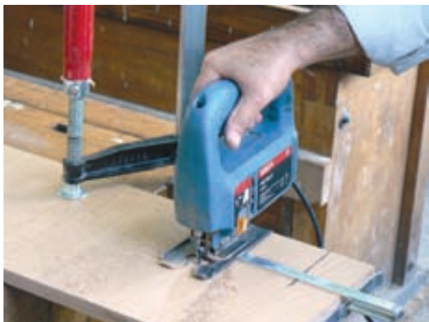
شکل ۲-۲۹- استفاده از گونیا در برش
