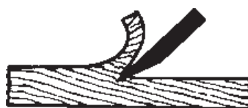
شکل ۳-۱۰- براه الیاف چوب
