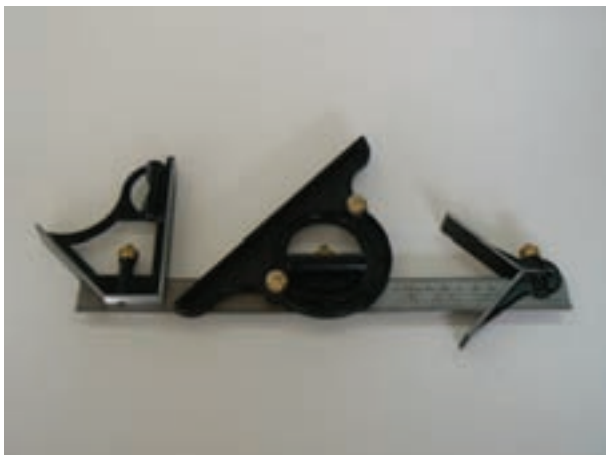
شکل ۱-۵- قسمتهای مختلف یک گونیای ساده و مرکب
