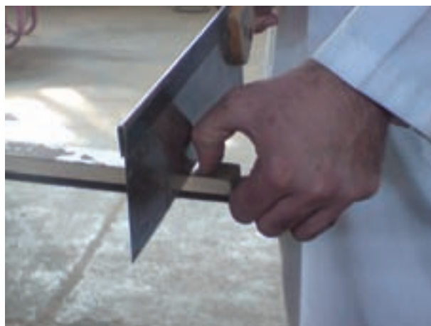
شکل ۳۳-۲- در شروع کار بعد از ایجاد شیار اولیه برش دست را از کنار اره دور کنید.
