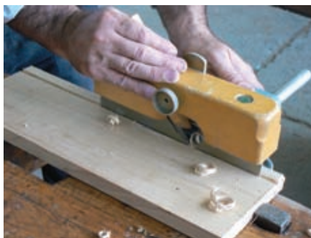
شکل ۳-۲۸ رنده چوبی کنشکاف قابل تنظیم
