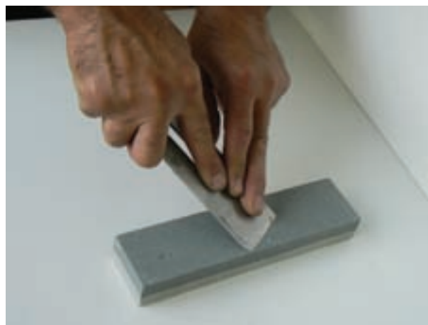
شکل ۳۴-۳- روش سنگ نفت زدن تیغه رنده
