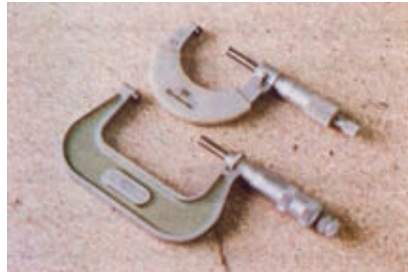
شکل ۱-۱۶- میکرومتر و قسمت‌های مختلف آن
