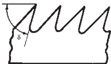
شکل ۱۰-۲- زاویه برش کمتر از ۹۰ درجه
