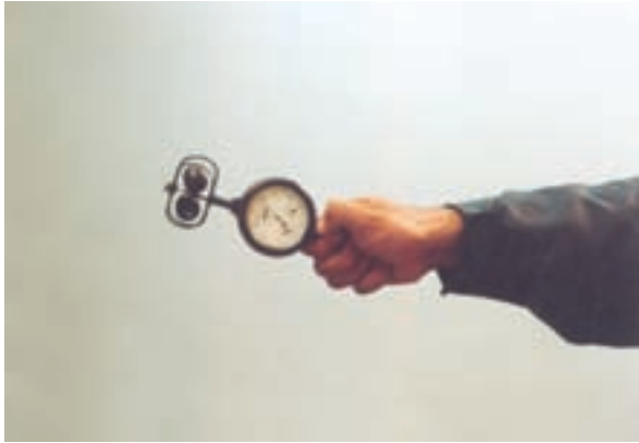
شکل ۸-۹ - طرز گرفتن هواسنج در مسیر جریان هوا
