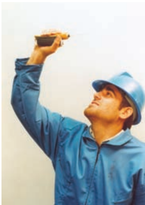
شکل ۱۵-۷ فشار دادن دستگاه برای جذب هوا
