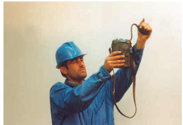
شکل ۷-۸- فشردن تلمبه لاستیکی و انتقال هوا به داخل اینترفرومتر
