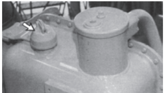
شکل ۶-۹۱ - پر کردن سیستم هیدرولیک فرمان از روغن
