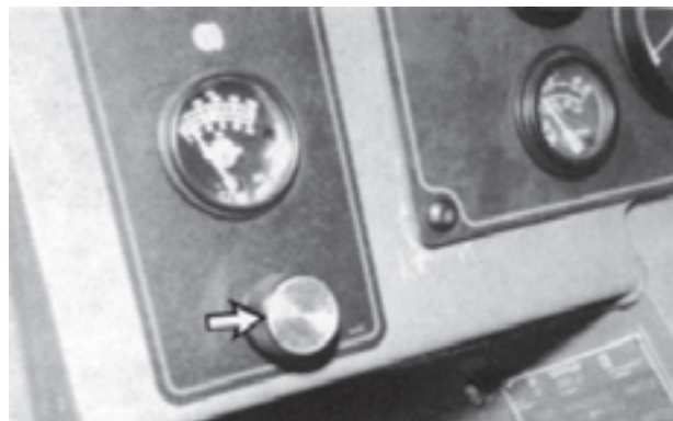
شکل ۴۴-۶- کنترل تمام چراغ‌های ماشین
