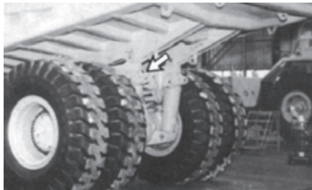
شکل ۴۸-۶ آزمایش زنگ خطر دنده عقب
