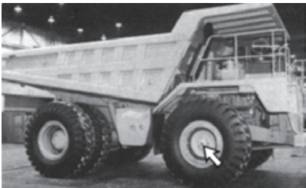
الف - درپوش محل پر کردن روغن یاتاقان‌های چرخ جلو
