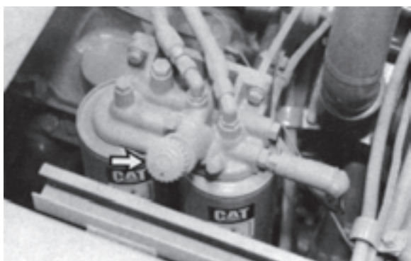
شکل ۷۰-۶- هواگیری سیستم سوخت
