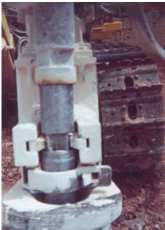
ب- حالت درگیر آچار راد بازکن
