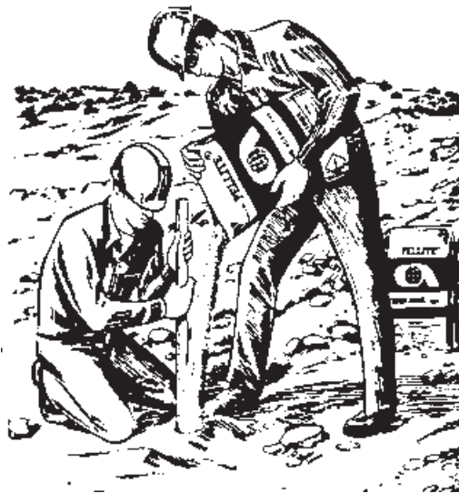
شکل ۷-۴- فشردن آنفو در چال با سنبه چوبی
