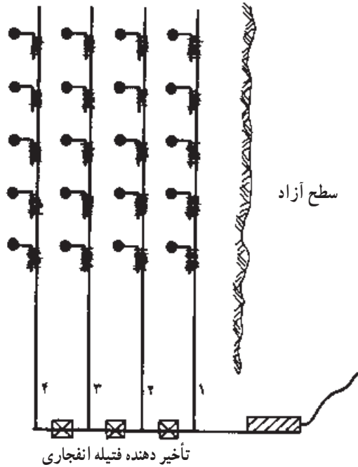
شکل ۳۱-۷- انفجار تأخیری با فتیله انفجاری و تأخیر دهنده فتیله انفجاری ردیف‌های ۱ و ۲ و ۳ و ۴ به نوبت آتش خواهند گرفت.
