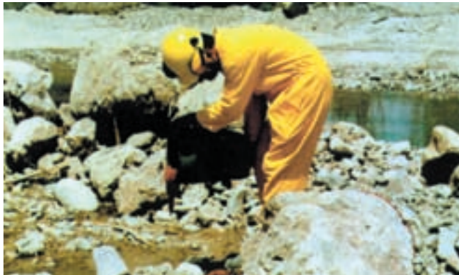
شکل ۲۸-۶- نحوه پرکردن جال‌های انفجاری با اسلاری
