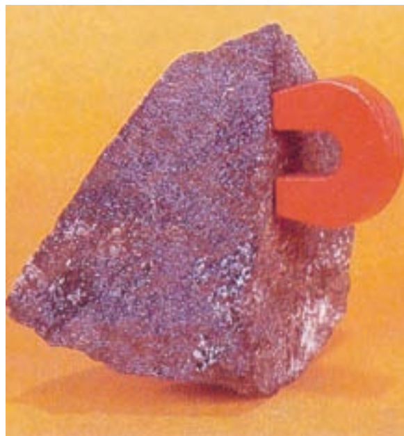
شکل ۵-۷ کاتالیزگر آمونیاک متشکل از کانی حاوی آهن‌اکسید
