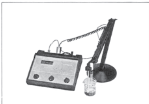
شکل ۲-۱۵- دو نوع pH سنج با دقت \pm 0.1 pH
