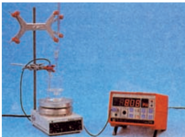
شکل ۴-۱۵- اندازه‌گیری pH به وسیله‌ی دستگاه pH سنج
