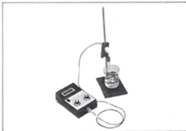
شکل ۲-۱۵- دو نوع pH سنج با دقت \pm 0.1 pH
