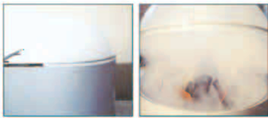
شکل ۱-۱۳- دستگاه تولید مه نمک (سالت اسپری Salt spray) مورد استفاده: بررسی مقاومت فیلم خشک رنگ در محیط‌های خوردنده نمکی
