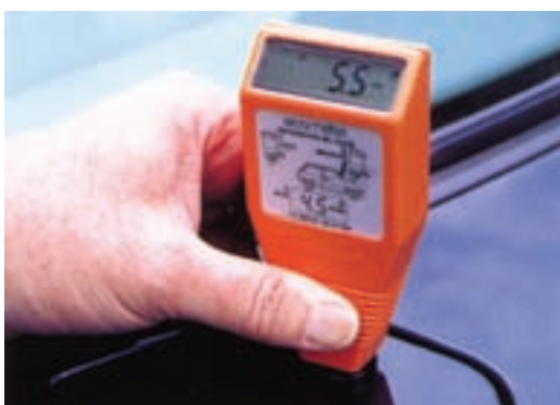
شکل ۱۱-۱۳- انواع ضخامت سنج فیلم خشک رنگ (غیر تخریبی)
