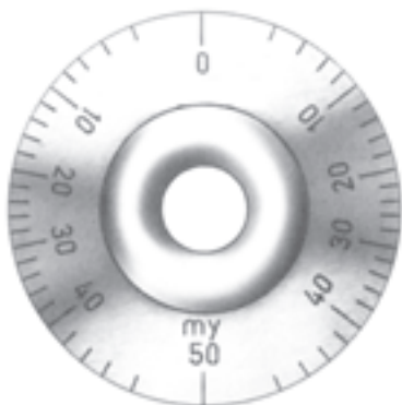
شکل ۹-۱۳- ضخامت‌سنج فیلم خشک رنگ (روش تخریبی)
