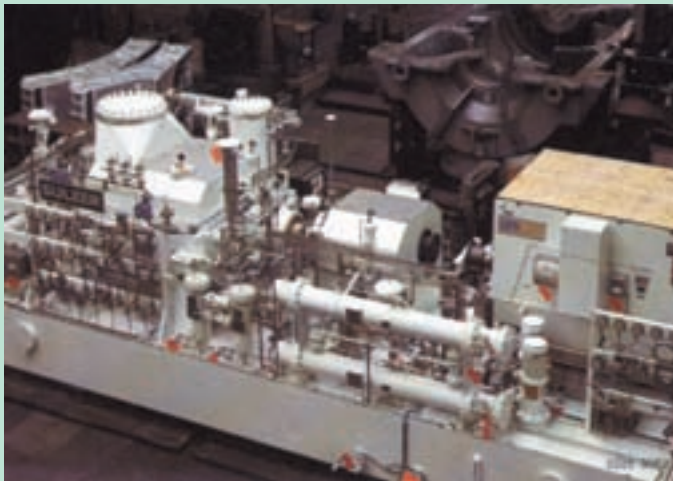
شکل ۷-۵-ج - کمپرسور استفاده شده در سیستم سردسازی
