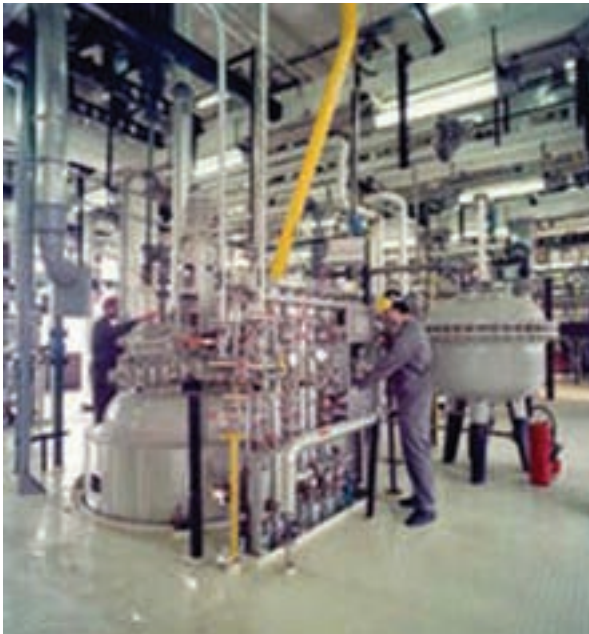
شکل ۶-۷ رآکتورهای تولید مواد اولیه دارویی در شرکت شیمی دارویی داروپخش
