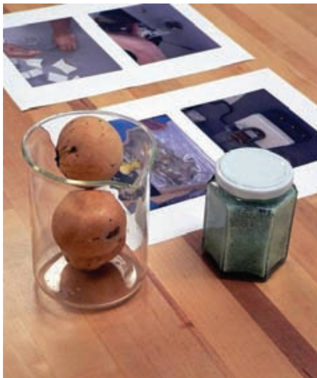
شکل ۷-۳- نوعی میوه درخت بلوط و پودر آهن خالص به عنوان مواد اولیه مرکب سازی
