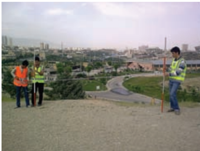
شکل ۴ - ۲. خطای افقی نبودن متر
