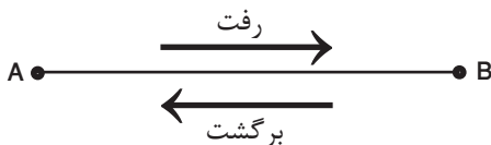
شکل ۲ - ۱۳. مترکشی به صورت رفت و برگشت
