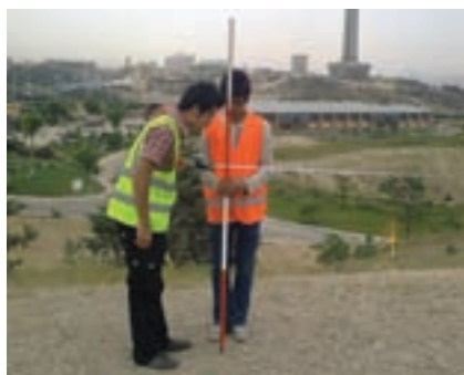
شکل ۲- ۱۴. زاویه صحیح قرائت متر
