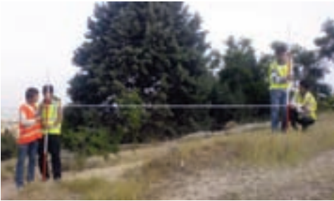
شکل ۲-۹. مترکشی افقی به صورت صحیح
