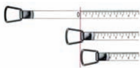
شکل ۲-۹. مترکشی افقی به صورت صحیح
