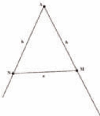
شکل ۶ - ۵. جدا کردن دو طول مساوی روی اضلاع زاویه
