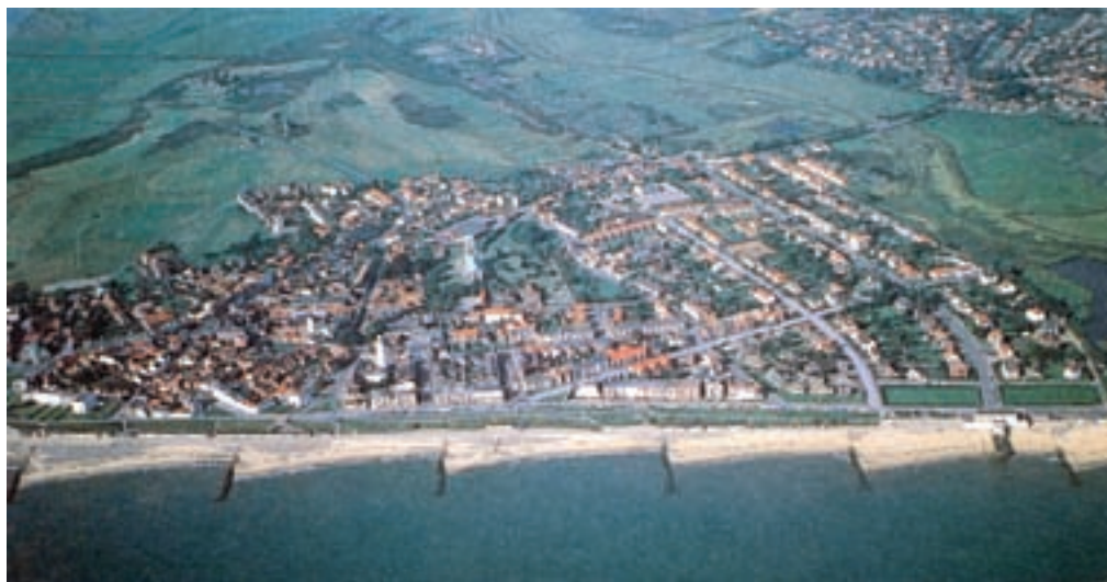
شکل ۸- احداث حفاظ در سواحل ماسه‌ای
