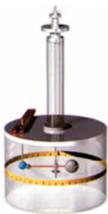
شکل ۲-۲۰- ترازوی پیچشی کولن
