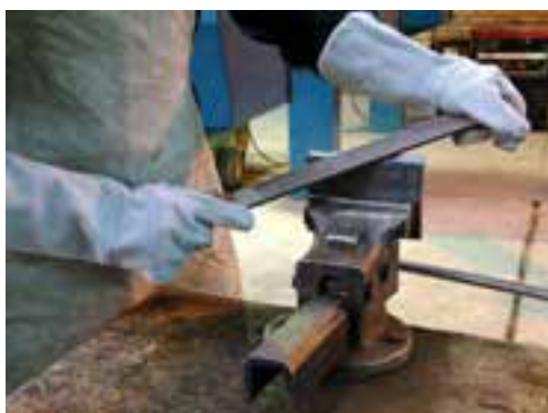
شکل ۴-۱۶- سوهانکاری سطح پخ
