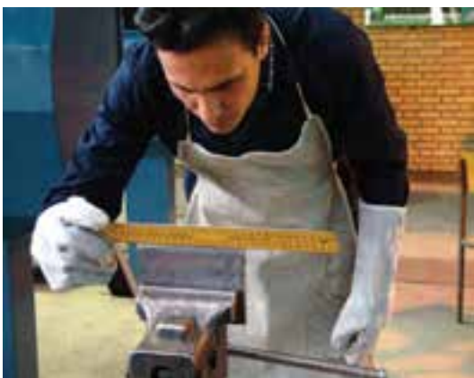
شکل ۴-۲۰- کنترل پاشنه جوش با گونیا
