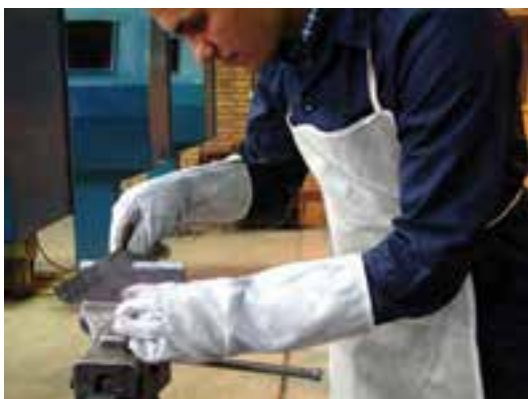
شکل ۴-۱۸- کنترل اندازه یخ و پاشنه‌ی جوش با سوهان
