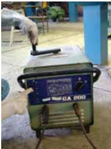
شکل ۱۶-۳- روش تنظیم آمپر در ترانسفورماتور
