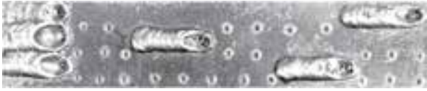
شکل ۲۹-۳- گرده جوش کوتاه و محل جوشکاری
