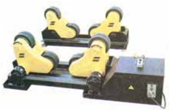
شکل ۲-۱۸- وضعیت دهنده‌ی غلتکی و غلتک‌های لاستیکی آن
