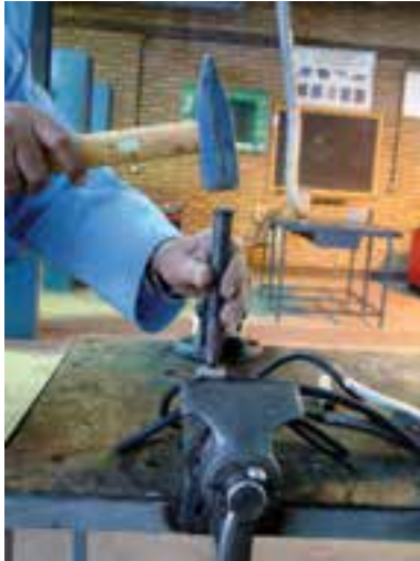
شکل ۲-۱۴ پرس کردن سر کابل به کابل شو
