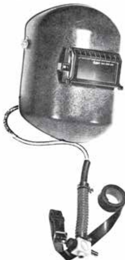
شکل ۲۹-۲- ماسک با لوله‌ی هوارسانی برای جوشکاری در محیط‌های کوچک و سر بسته
