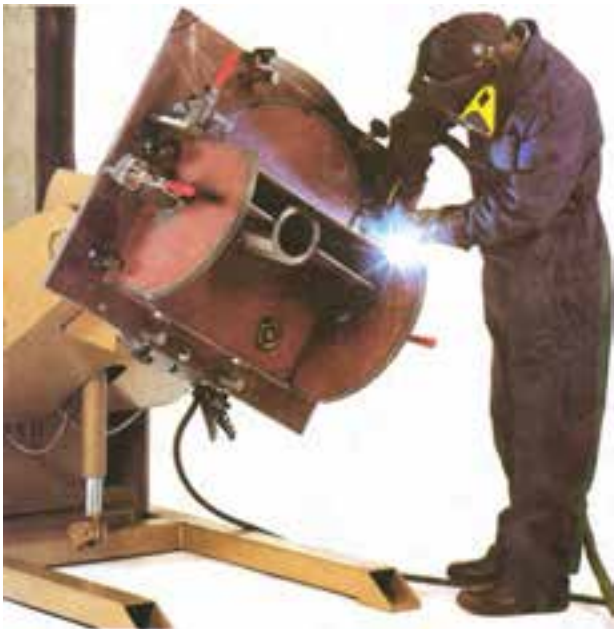
شکل ۲-۱۷- جوشکاری با استفاده از وضعیت دهنده و بست و گیره‌های مخصوص آن
