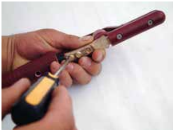
شکل ۱۰-۲- روش محکم کردن کابل داخل سوراخ انبر
