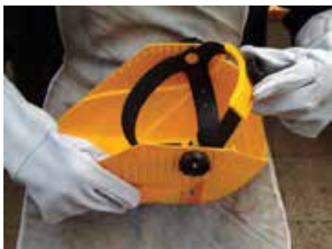
شکل ۲-۲۸- الف - تنظیم بست ماسک کلاهی
