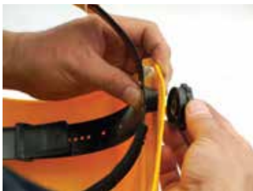
شکل ۲۸-۲-ب - ماسک کلاهی و پیچ قابل تنظیم
