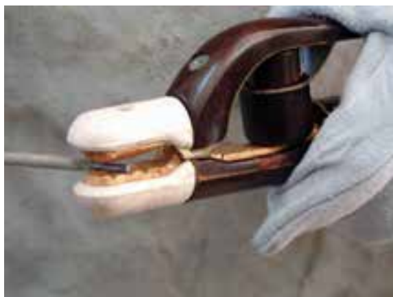
شکل ۲-۵- دهانه انبر و شیارهای آن
