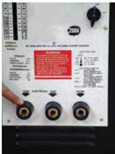
شکل ۱-۲۶- محل وصل فیش کابل انبر برای آمپرهای زیاد
