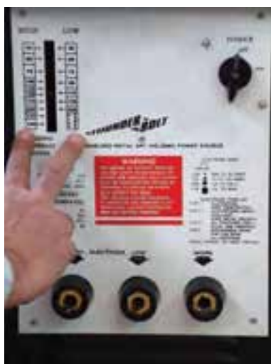
شکل ۱-۲۳- ترانسفورماتور جوش با دو ردیف درجه‌ی قابل تنظیم آمپر
