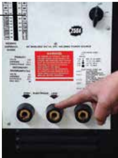
شکل ۱-۲۵- محل وصل فیش کابل انبر
