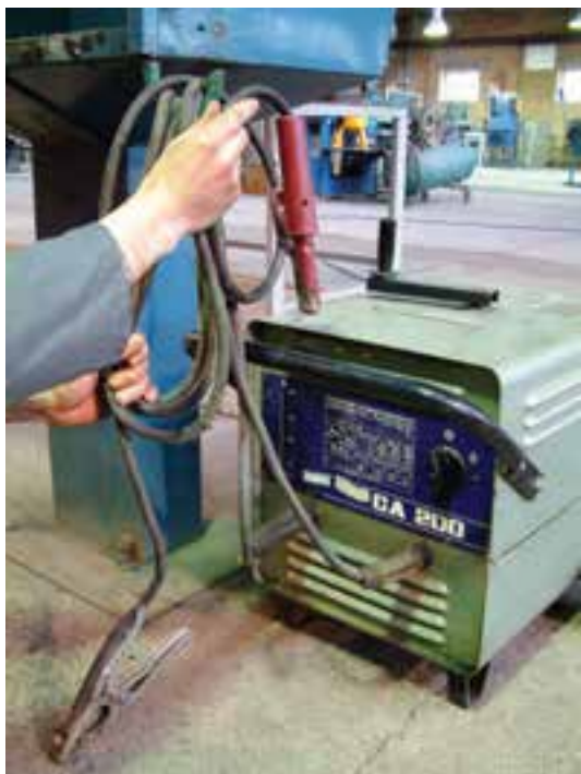
شکل ۱-۳۱- کلید اصلی روی O و دستگاه خاموش است.
