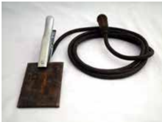
شکل ۱-۱۲- کابل رشته‌ای مسی که به انبر اتصال وصل شده است.
