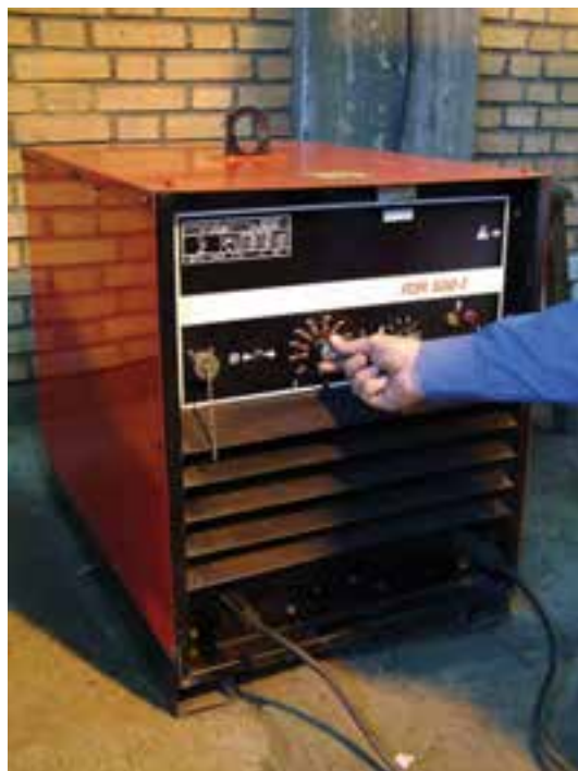
شکل ۱-۳۵- تنظیم آمپر در رکتیفایر جوش
