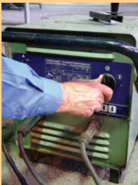
شکل ۱-۲۸- دستگاه جوشکاری در حالت خاموش
