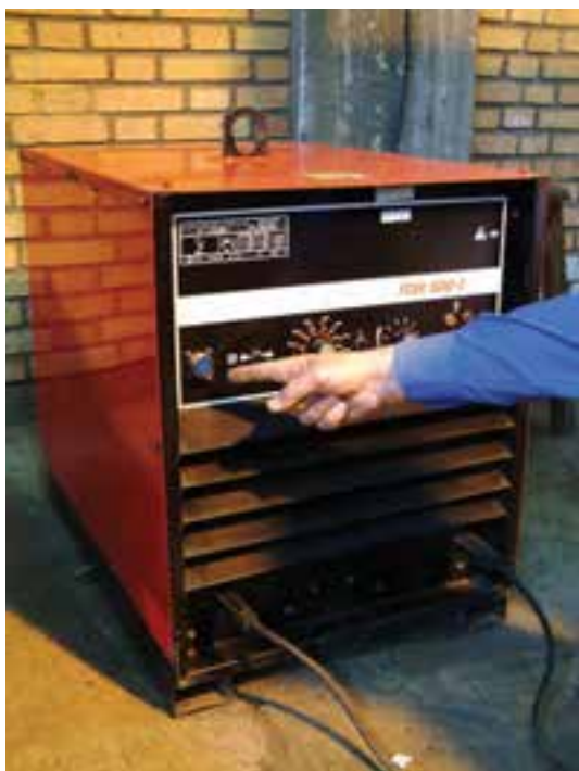
شکل ۱-۳۶- محل اتصال فیش کنترل از دور دستگاه
