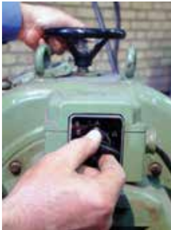
شکل ۵۲-۱- کلید در حالت O
