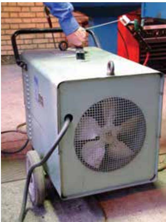
شکل ۱-۳۰- پروانه‌ی خنک‌کن دستگاه
