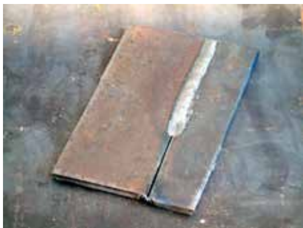
شکل ۱-۲- ذوب شدن لبه‌های کار و الکتروود
