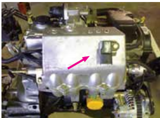
شکل ۱-۱۴- مکان نصب سنسور فشار و دمای هوا
