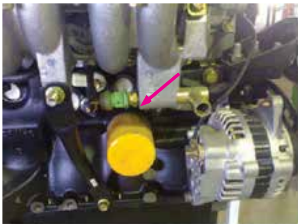
شکل ۱۶-۱- مکان نصب سنسور دمای آب
