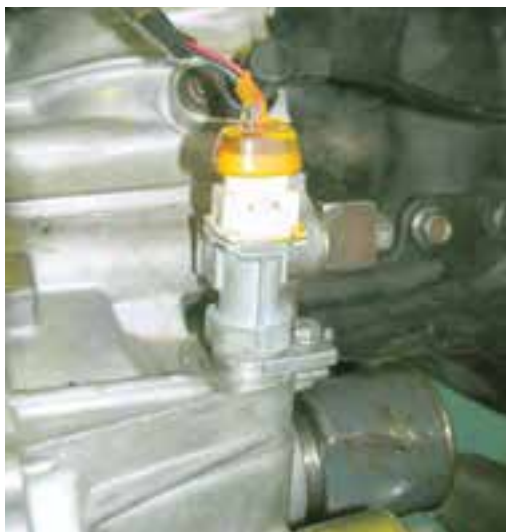
شکل ۱-۲۴- مکان نصب سنسور سرعت خودرو
