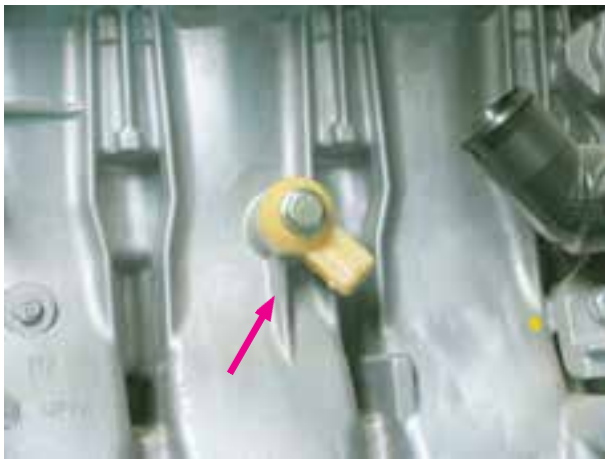
شکل ۱-۲۶ مکان نصب سنسور ناک
