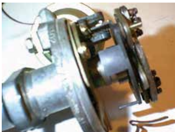
شکل ۱۱-۱- دلقوی الکترونیکی با حسگر اثرهال
