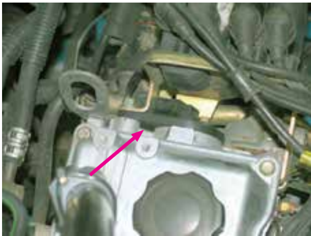
شکل ۱-۲۲- مکان نصب سنسور موقعیت میل سوپاپ
