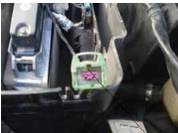
شکل ۳۰-۱- مکان نصب واحد کنترل الکترونیکی
