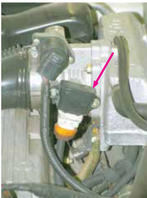
شکل ۱۸-۱- مکان نصب سنسور موقعیت دریچه گاز
