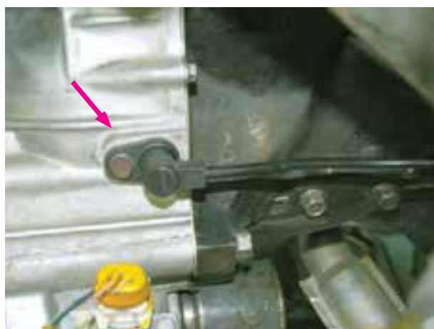
شکل ۱-۲۰- مکان نصب سنسور دور موتور
