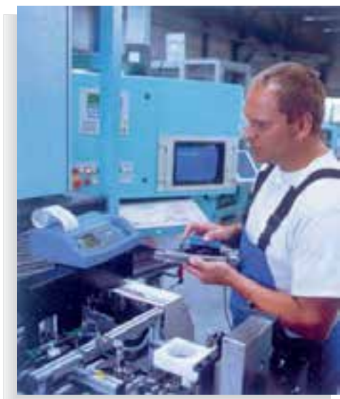
کنترل کیفیت سطح یک محور با استفاده از دستگاه سیار زبری سنج
